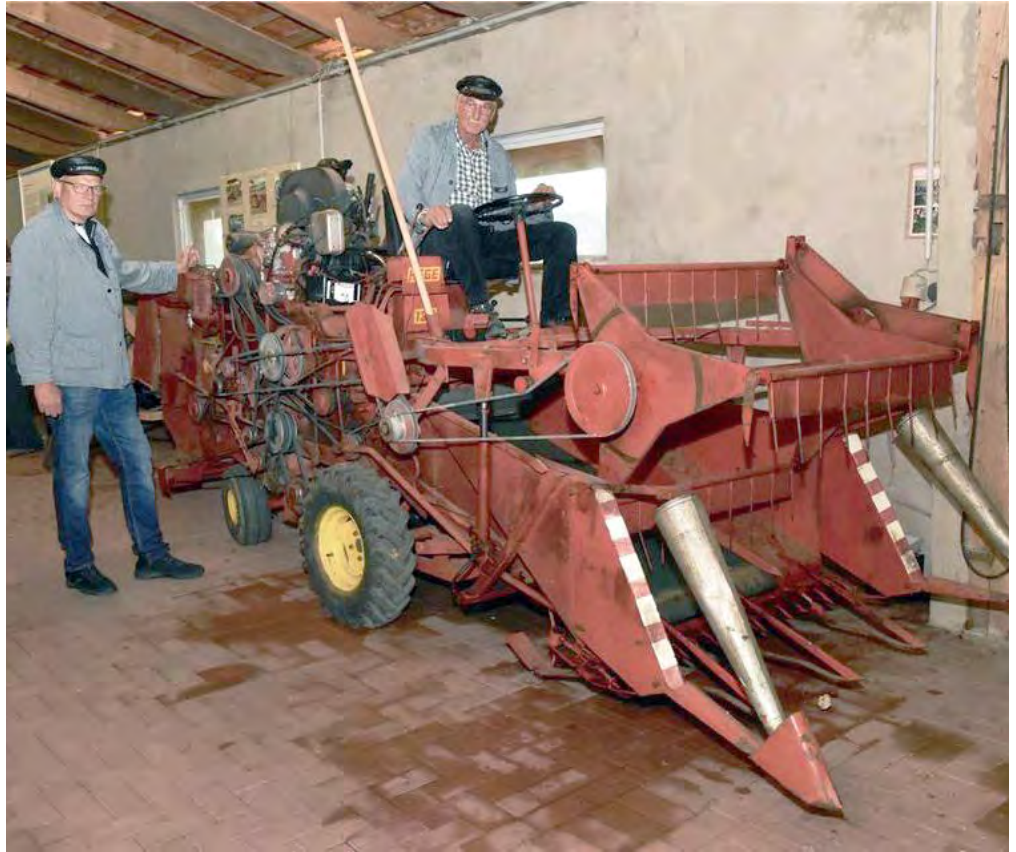
Der altertümliche Hege-Parzellenmähdrescher: Josef Schüttert (am Lenkrad) und Alfons Flasche führen ihn in der Hofscheune vor.
