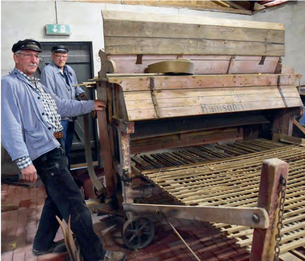
Ein Breitdrescher ohne Kornreinigung (um 1900): Josef Schütttert (links) und Alfons Flasche zeigen die historische Erntemaschine aus Holz.
