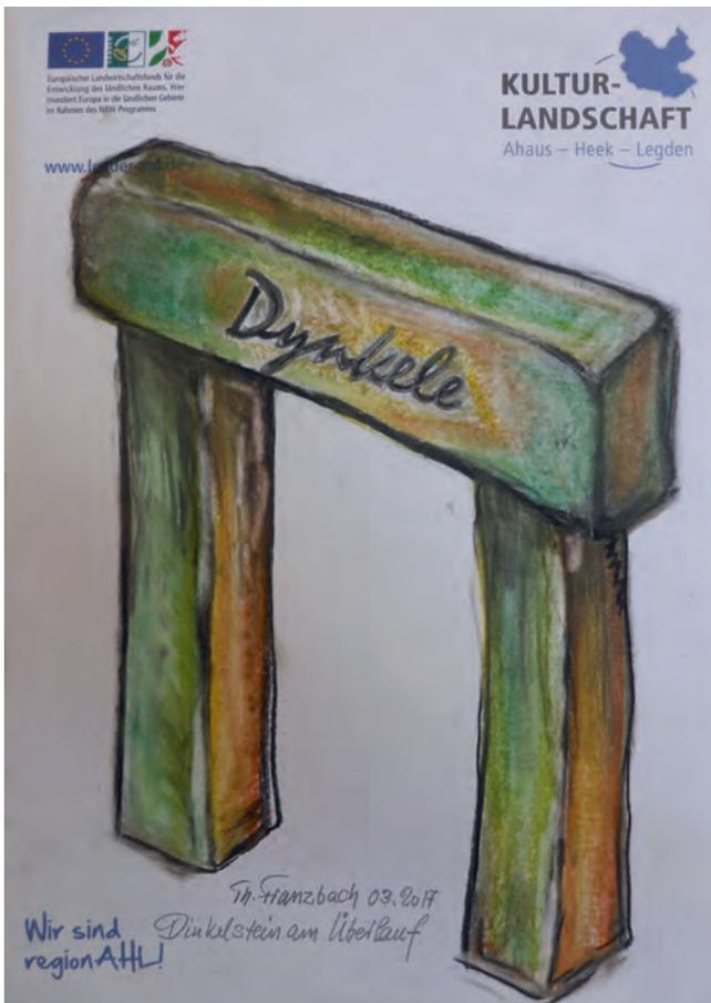
So könnte der Dinkelstein in Form eines Torbogens am Dinkelüberlauf am Überlauf aussehen: Torbogen aus drei Steinen mit etwa rechteckigem Querschnitt; Durchgang: lichte Höhe 2,0 m; lichte Breite ca. 1,2 m; Schriftzug: „Dynkele“ aus Edelstahl.
